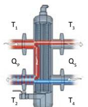
Этой ситуации подача выше потребности. Это приведет к уменьшению разности  $\Delta T$  T1 и T2. Некоторая часть воды подачи будет включена в обратную воду, в результате чего снизится эффективность нагревателя или охладителя. По возможности нужно отрегулировать мощность в меньшую сторону.
