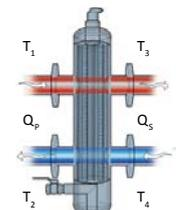
В редком случае подача и потребность хорошо скомпенсированы. Это идеальная ситуация, при которой гидрострелка в действительности лишняя.
